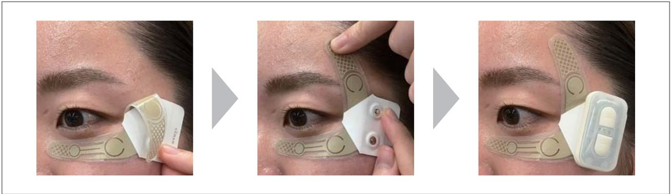
図1 目元専用フレキシブル薄膜 EMS 電極の貼り付け方
